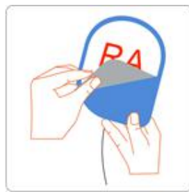
Figura 21: Removendo a película protetora do eletrodo
