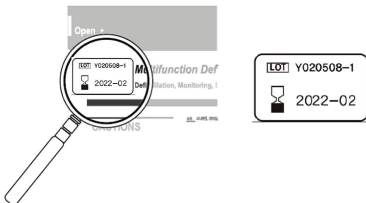
Figura 47: Verificando o prazo de validade dos eletrodos
